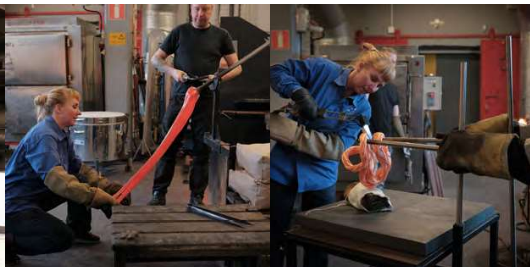
Page de gauche : à la Glass Factory, Maria travaille avec Mikael et Anders : après que le verre chaud a été étiré et plié plusieurs fois puis tordu, il est sur le point d'être coupé pour le séparer de la canne. Il sera ensuite façonné à la main par Maria protégée par des gants en kevlar. Ci-dessus : Maria étirant le verre chaud (gauche). Quelques secondes avant de placer l'œuvre dans l'arche de recuisson, Maria brûle certaines parties. Quand il est chaud, le verre est toujours orange, puis celui-ci se révélera finalement d'un jaune intense (droite).
